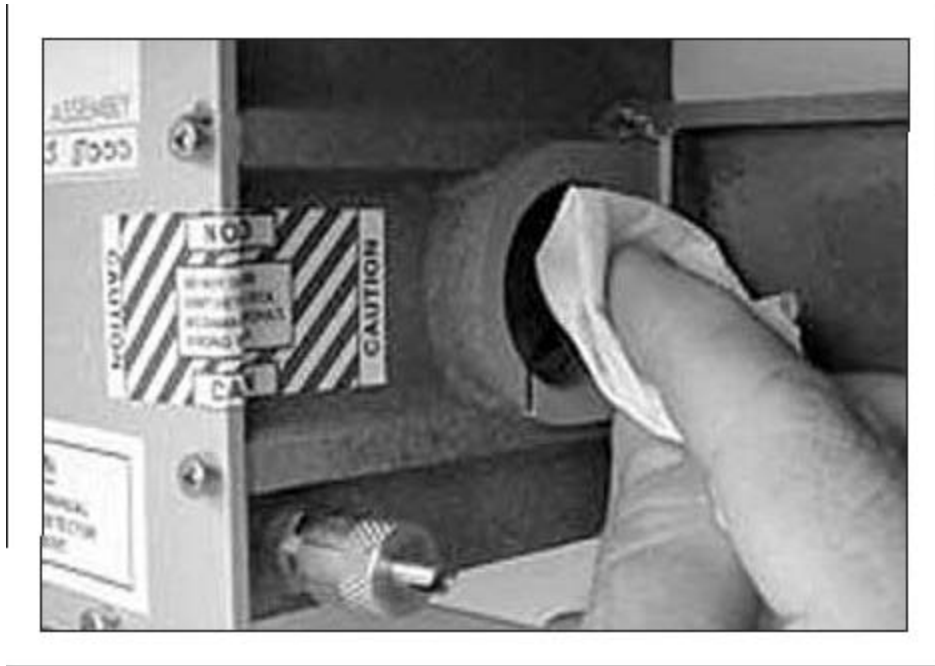
图 41 清洗 IR 工作台组件中的宝石视窗
